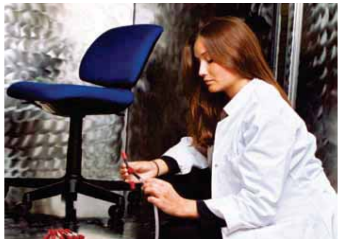
Pour des spécimens hétérogènes, Eurofins réalise des études sur des objets entiers dans une grande chambre de test.
